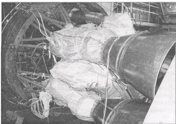
Рис. 9. Двигатель с сажезащитными чехлами на стенде
